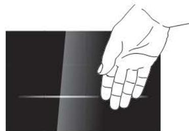
**4** Coprire contemporaneamente entrambi i tasti di azionamento con le mani ad una distanza di circa 5 cm, finché entrambi i tasti di azionamento lampeggiano una volta.
