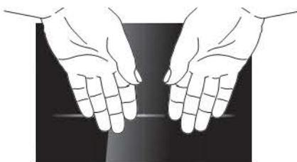
**2** Coprire il tasto di azionamento sinistro con la mano fino a quando non si accende in colore arancione. Lampeggiando, il tasto di azionamento destro indica ripetutamente l'impostazione attuale (un lampeggio = impostazione 1, due lampeggi = impostazione 2, tre lampeggi = impostazione 3).
