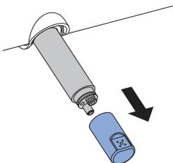
**4** Ersetzen Sie die Dushdüse, falls sie sich nicht mehr vollständig reinigen und entkalken lässt.
