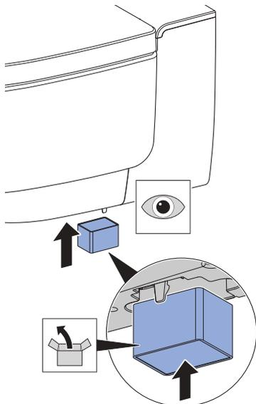
✓ Le ressort à détente maintient le filtre en place.
