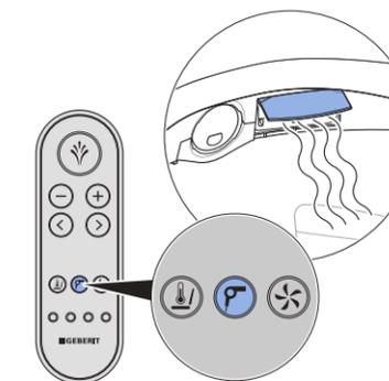
**i** Le fonctionnement du séchoir peut être démarré avec la touche <Séchoir> pendant le fonctionnement de la douchette. Le fonctionnement du séchoir interrompt celui de la douchette.
